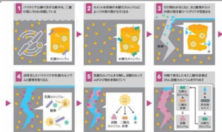
2018/5/15 日経クロステック、コンクリートが自己治癒するメカニズム (出所：日経ビジネス) 引用
