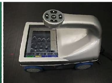
電磁波レーダ法(SIR)
