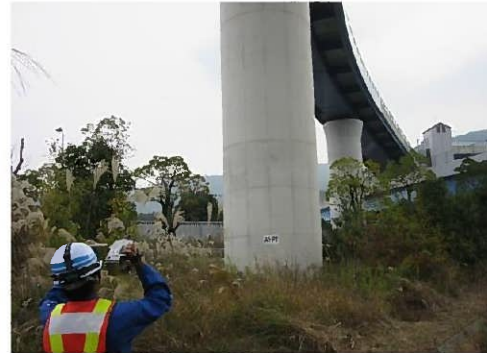
赤外線サーモグラフィーによる計測例(丸で囲んだ箇所がうき箇所)
