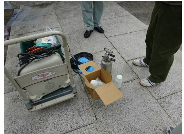
酸化チタンコートの吹付用機器
