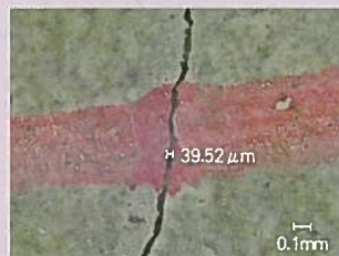
④ 補修後荷重を加え、強制的にひび割れさせた状態
