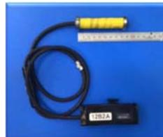
コンクリート構造物内部の鉄筋・コンクリートに生じる「ひずみ」を無線で計測
